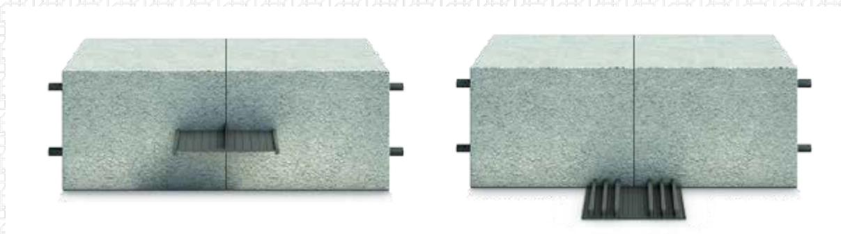
Внутренние шпонки защищены слоем бетона от внешних воздействий и могут выдерживать давление воды с любой стороны, боковые же должны прижиматься давлением воды к бетону.
