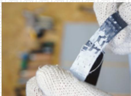
Разрыв качественного шва должен происходить по материалу, с обнажением армирующей сетки. Измерьте ширину шва – он должен составлять не менее **30 мм**.
