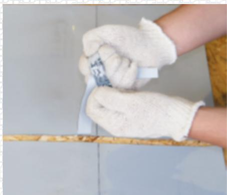
Для определения качества шва без применения оборудования можно использовать полосу сваренной мембраны шириной **20-30 мм**. Разорвите полосу сваренной мембраны руками.
