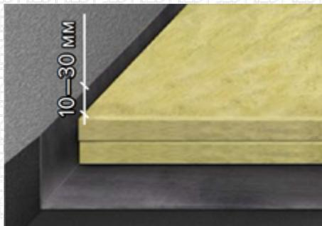
3. При подведении пароизоляции боковой стороной к вертикальной конструкции, материал укладывается вплотную к вертикальной поверхности.
