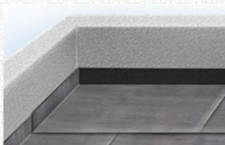
4. Наклеивается на вертикальную поверхность дополнительный слой со стороны рулона, который уложен вплотную к вертикальной конструкции.
