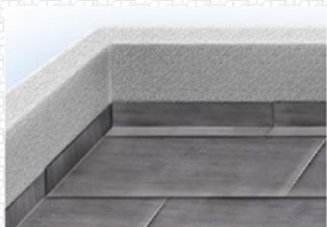
5. Дополнительный слой должен быть уложен на вертикальной поверхности выше теплоизоляционного слоя и заходить на горизонтальную поверхность основания на 150 мм.
