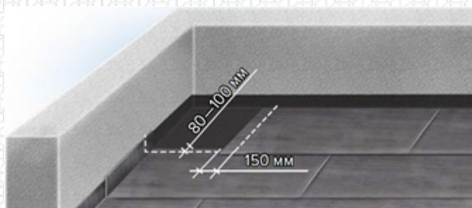
2. Соседние полотна укладываются с разбежкой торцевых швов.
