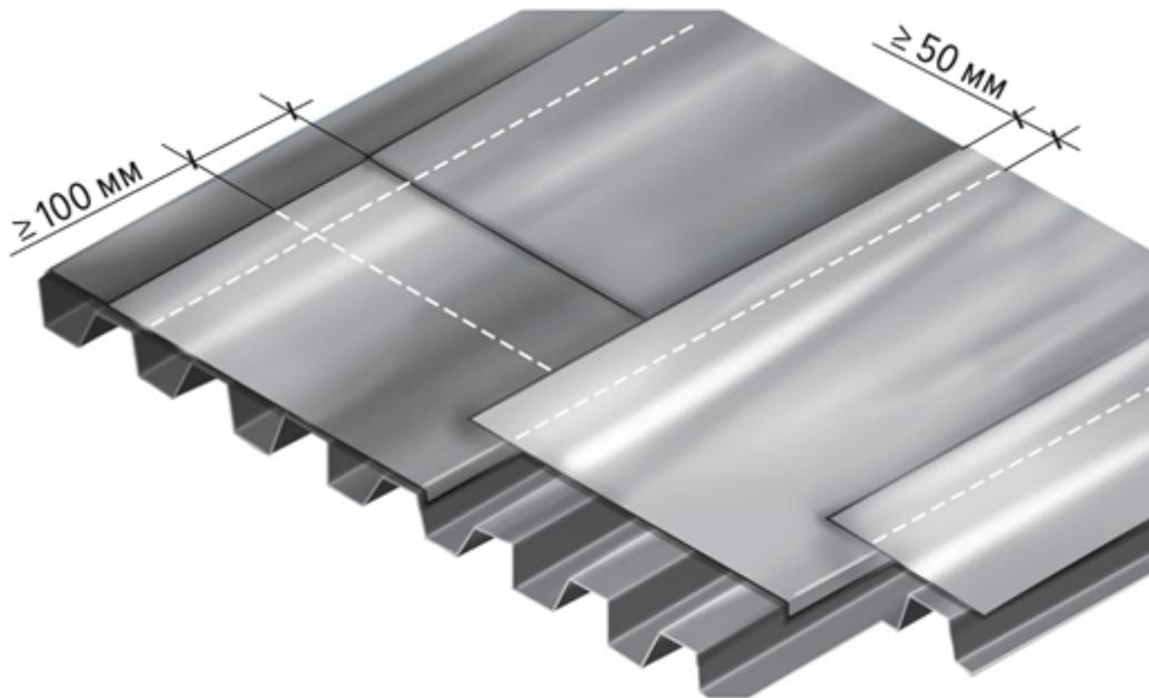
Важно! Перед началом укладки пароизоляционной мембраны раскатайте рулон на 2 м, выставите все необходимые нахлесты и приклейте начало рулона.
