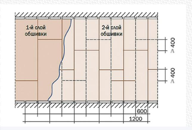
**ВАЖНО!** ГКЛ должен отступать на 10 мм от пола и на 5 мм от потолка. В дальнейшем эти зазоры заделываются виброакустическим герметиком и выступают в роли деформационных швов.
