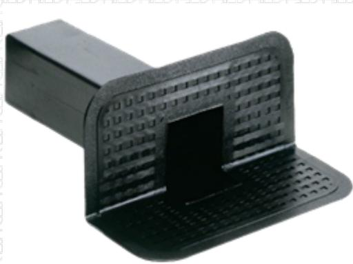
Воронка ULTRA парапетная 110 — воронка является парапетным переливом, которая устанавливается в случаях аварийного сброса воды при засорении основной воронки внутреннего водостока.
