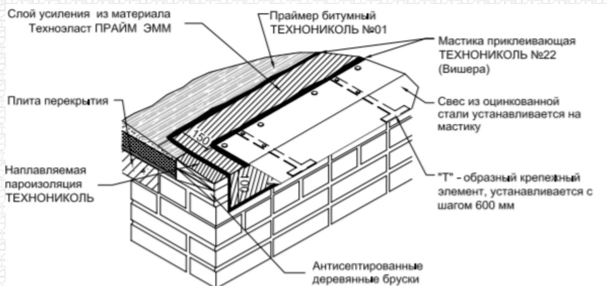
Нанесение мастики должно происходить непосредственно перед наклеиваемым рулоном. В случае если на нанесенную на основание мастику материал не был уложен в течение 5 мин, необходимо нанести дополнительный слой мастики перед приклейкой. Мастику приклеивающую ТЕХНОНИКОЛЬ №22 (Вишера) наносят по всей площади приклейки. На место бокового шва также наносят мастику. При укладке материала к основанию расход мастики составляет 1,4–1,8 кг/м<sup>2</sup>.
