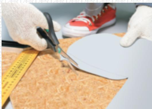
Соедините радиусы окружности так, чтобы получилась воронка с перехлестом на величину сварного шва (**20 мм**).
