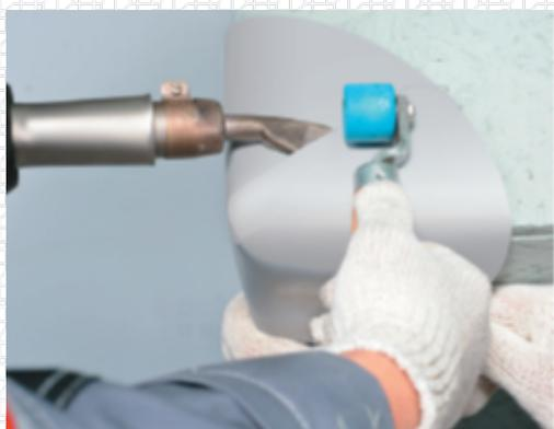
Выверните деталь наизнанку и проварите шов с внутренней стороны. Проверьте качество сварного шва пробником.
