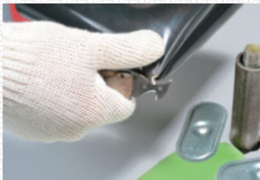
Прогревайте заготовку горячим воздухом, равномерно водя феном вокруг отверстия, пока мембрана в месте прогрева не станет пластичной.
