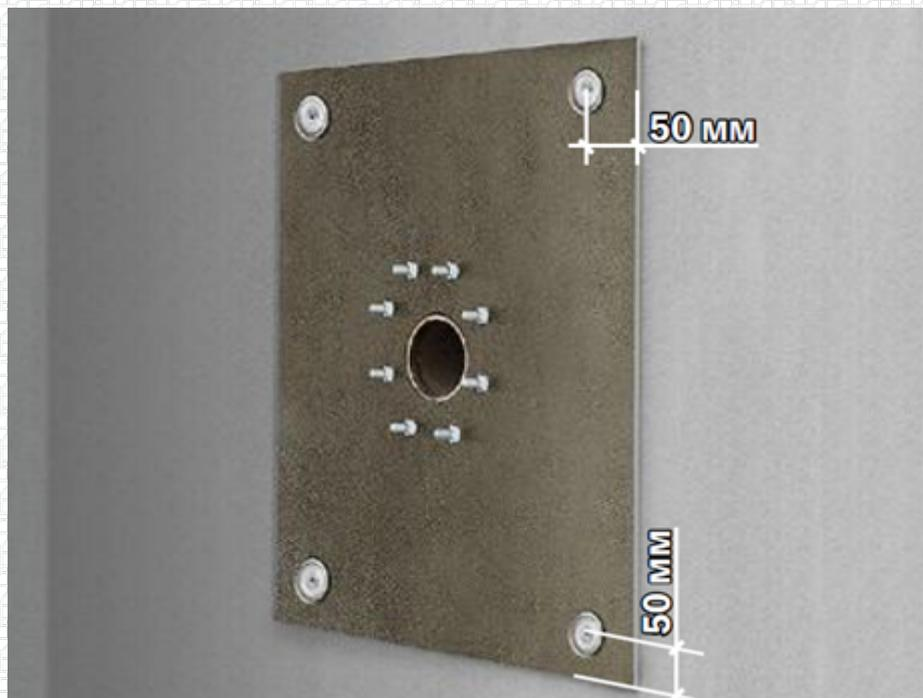
При устройстве слоев усиления трубных проходок необходимо край внутреннего отверстия слоя усиления наплавить на фланец трубной проходки. Механическую фиксацию слоя усиления трубной проходки можно выполнять при ширине фланца 150 мм. При меньшей ширине слой усиления должен быть полностью наплавлен на основание.
