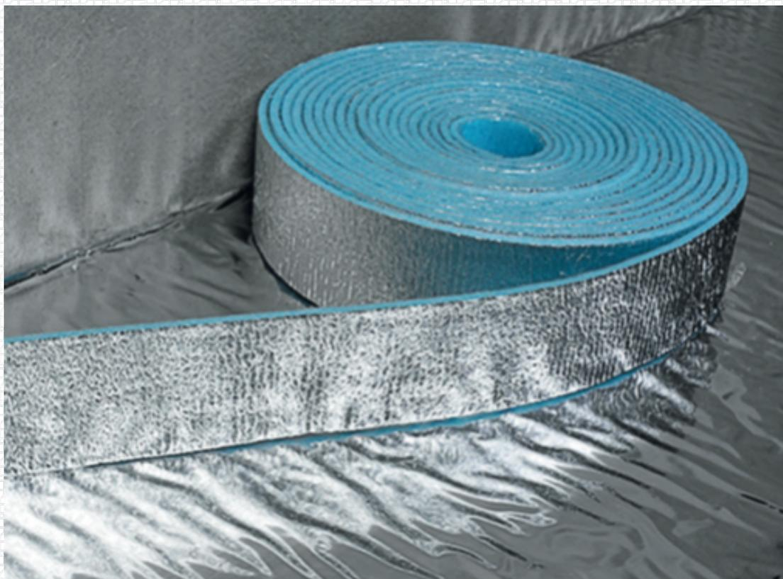
Демпферная лента полностью изолирует напольное покрытие от вертикальных конструкций, предотвращает образование звуковых мостиков с вертикальными конструкциями и компенсирует возможное расширение самой стяжки в процессе эксплуатации (устройство теплого пола, изменение микроклимата внутренних помещений).
