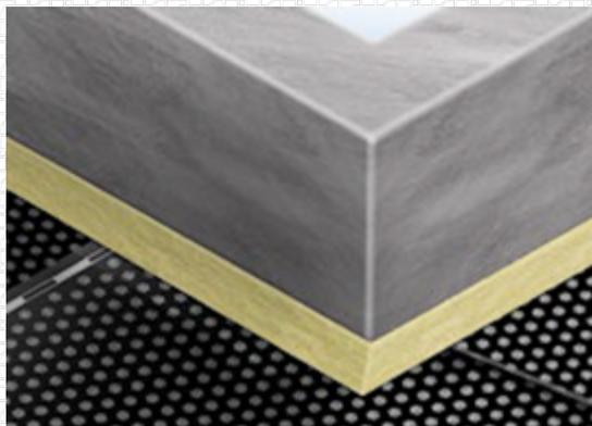
Установите и наплавьте полосы слоя усиления из материала Техноэласт ЭПП.
