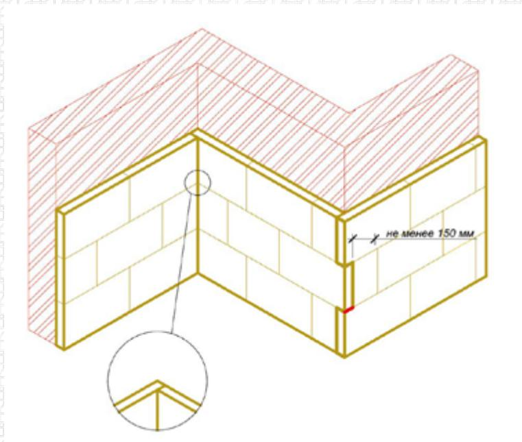
В сплошном теплоизоляционном слое предусматриваются температурные деформационные швы по осевым отметкам существующих деформационных швов здания и с интервалом 24 м (в теплоизоляционном слое из плит на основе каменной ваты).
