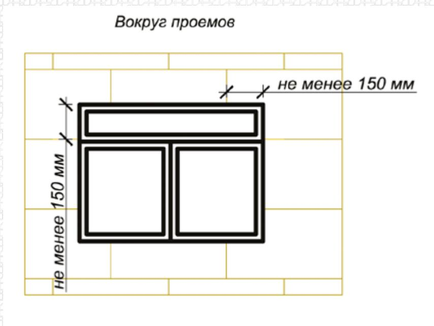
Если оконные и дверные блоки смонтированы в плоскости фасада, то теплоизоляционные плиты следует устанавливать с напуском на коробку блока не менее 2 см. Предварительно по
