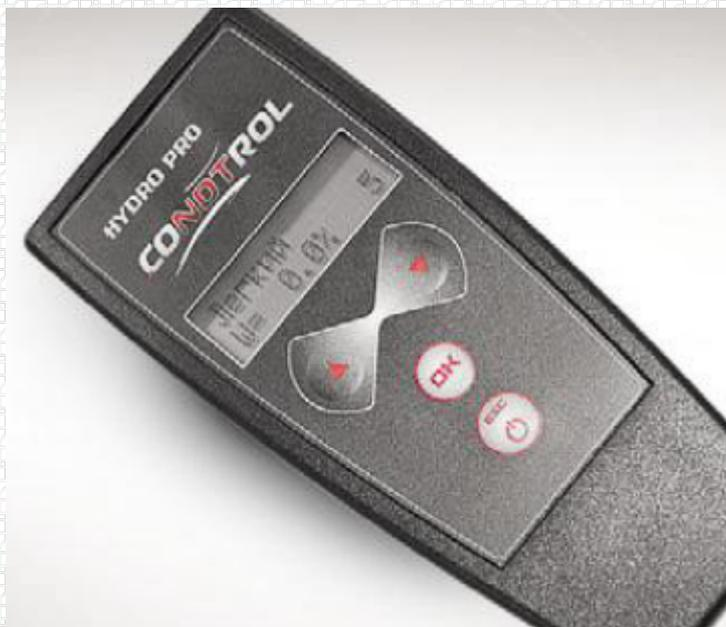
Одним из важных этапов при подготовке основания является контроль его влажности. Согласно ГОСТ 12730.2-78 различают влажность бетона по массе ( $W_m$ ) и влажность бетона по объему ( $W_o$ ).
