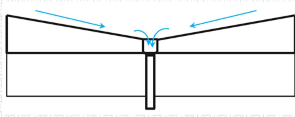
При устройстве внутренних водостоков в неотапливаемых зданиях при отрицательной температуре наружного воздуха следует предусматривать мероприятия, обеспечивающие положительную температуру в трубопроводах и водосточных воронках (электрообогрев, обогрев с помощью пара и т.д.).
