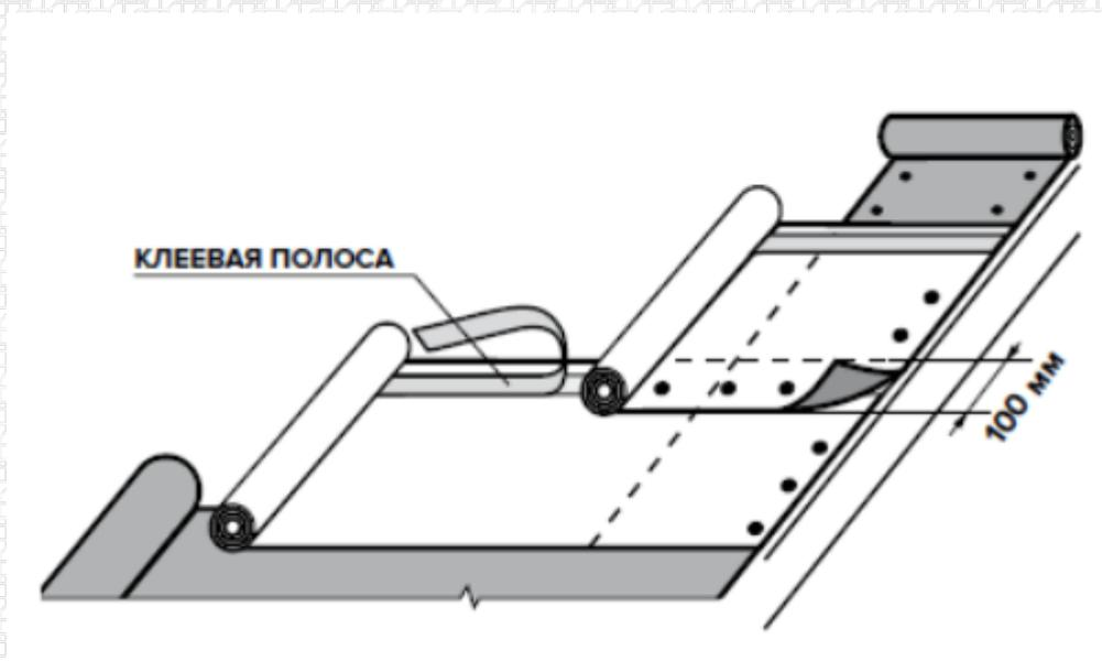
Плѐнка выполнена только по плоскости, которая образует продольный перехлѐст на ширину 100 мм
