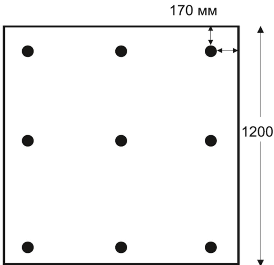
Примечание: При обрезании плиты количество крепежа рассчитывается, исходя из одного винта с шайбой на 0,14 м<sup>2</sup> плиты.
