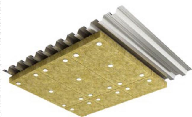
Необходимо приложить плиту из каменной ваты к защищаемой поверхности настила из стальных профилируемых листов и прикрепить самосверлящими самонарезающими винтами с надетыми на них шайбами к нижней полке профлиста. Винты вкручиваются в настил при помощи шуруповертов.
