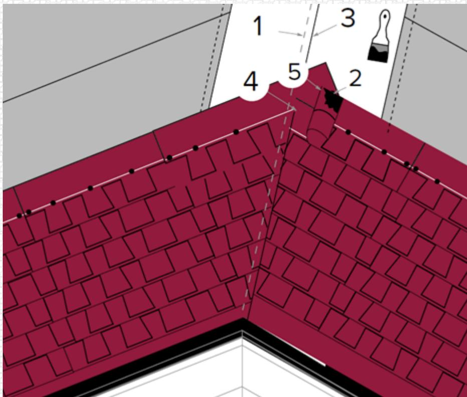
Произвести разметку на подкладочном ковре линии фиксации (2) гибкой черепицы на расстоянии не менее 300 мм от оси ендовы (1).
