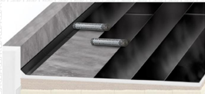
Торцевую часть рулона можно завести на наклонный бортик без устройства слоя усиления. Это возможно только при подведении рулона к вертикальной конструкции торцевой частью: на вертикальную поверхность торцевая часть рулона должна заходить на 25 мм выше от наклонного бортика.
