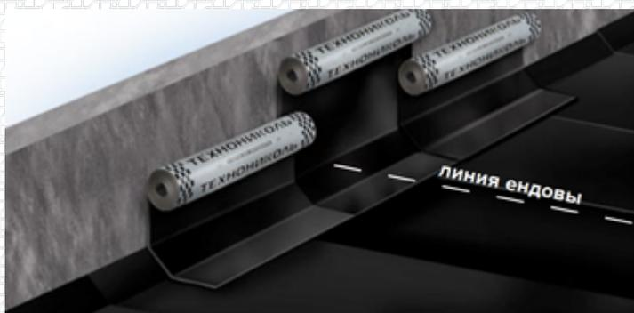
Дополнительный нижний слой должен заходить на вертикальную поверхность парапета на высоту не менее 250 мм и на горизонтальную поверхность основания на 150 мм от наклонного бортика. Парапеты высотой до 450 мм могут быть полностью обклеены (в примере рассмотрен именно данный вариант примыкания к парапету).
