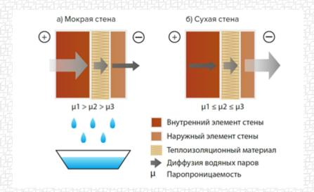
Важно! В современном энергоэффективном строительстве намеренно могут применяться паронепроницаемые ограждающие конструкции по принципу «термоса». В этом случае за регулирование влажности отвечает приточная и вытяжная вентиляционная система дома. Поэтому при выборе полимерных материалов с низкой паропроницаемостью следует особое внимание уделять системе вентиляции.
