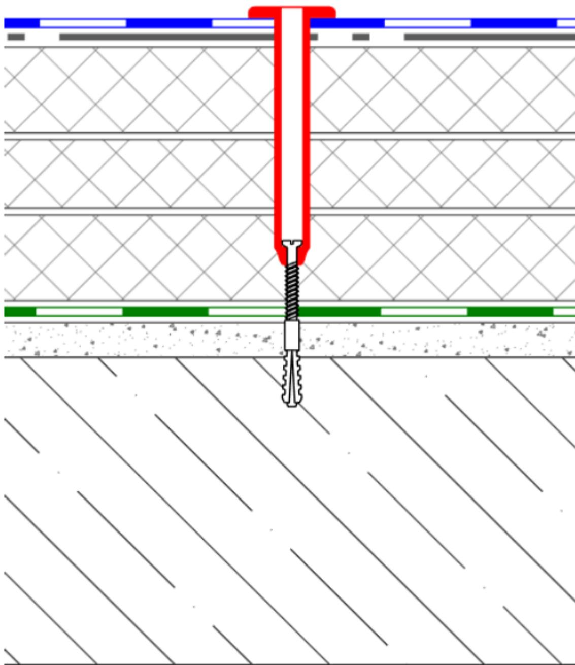
**Таблицы подбора телескопического крепежа для плотного основания
