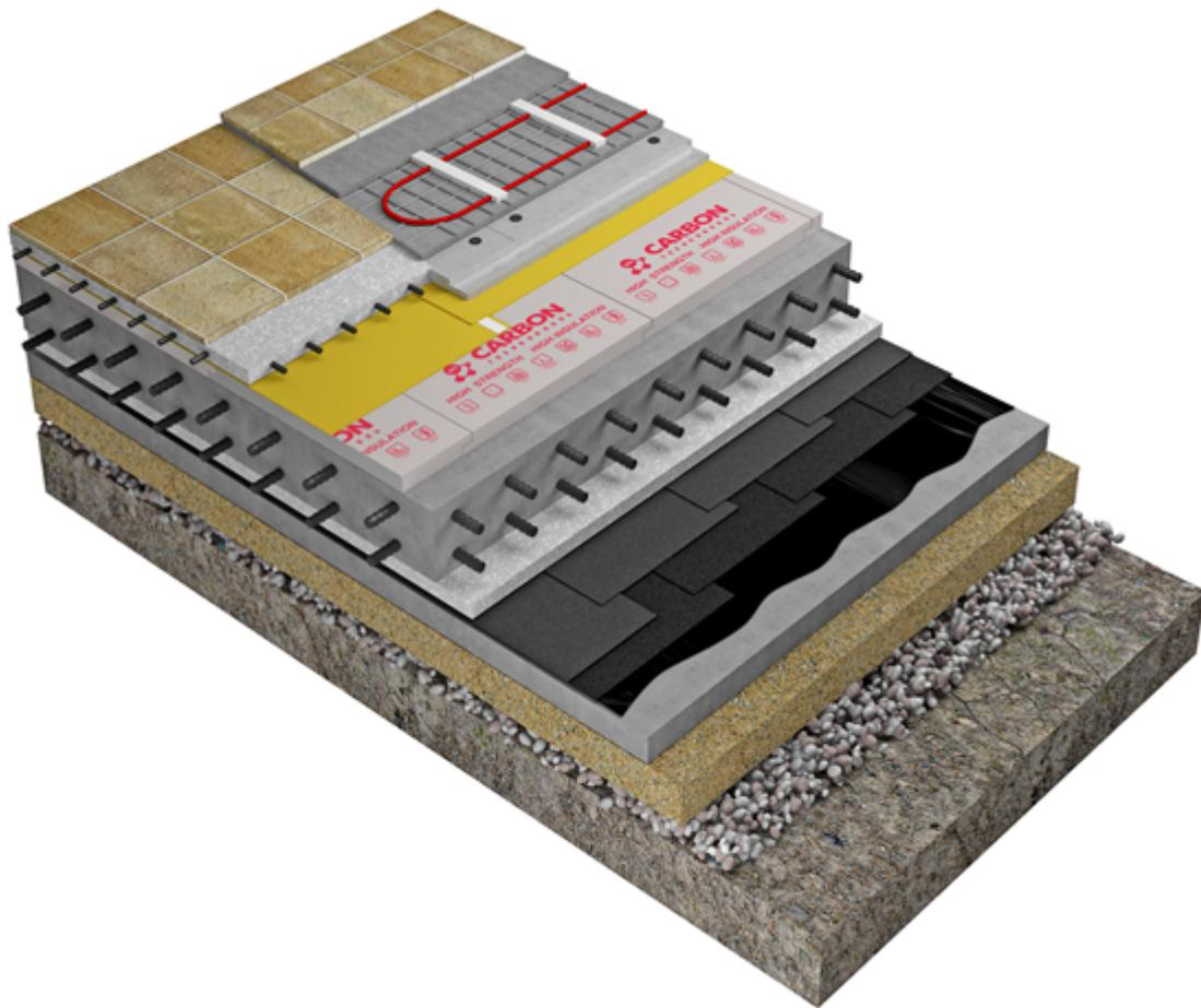
При утеплении пола по грунту плитами экструзионного пенополистирола XPS важным преимуществом является то, что данный материал способен выдерживать высокие сжимающие нагрузки.
