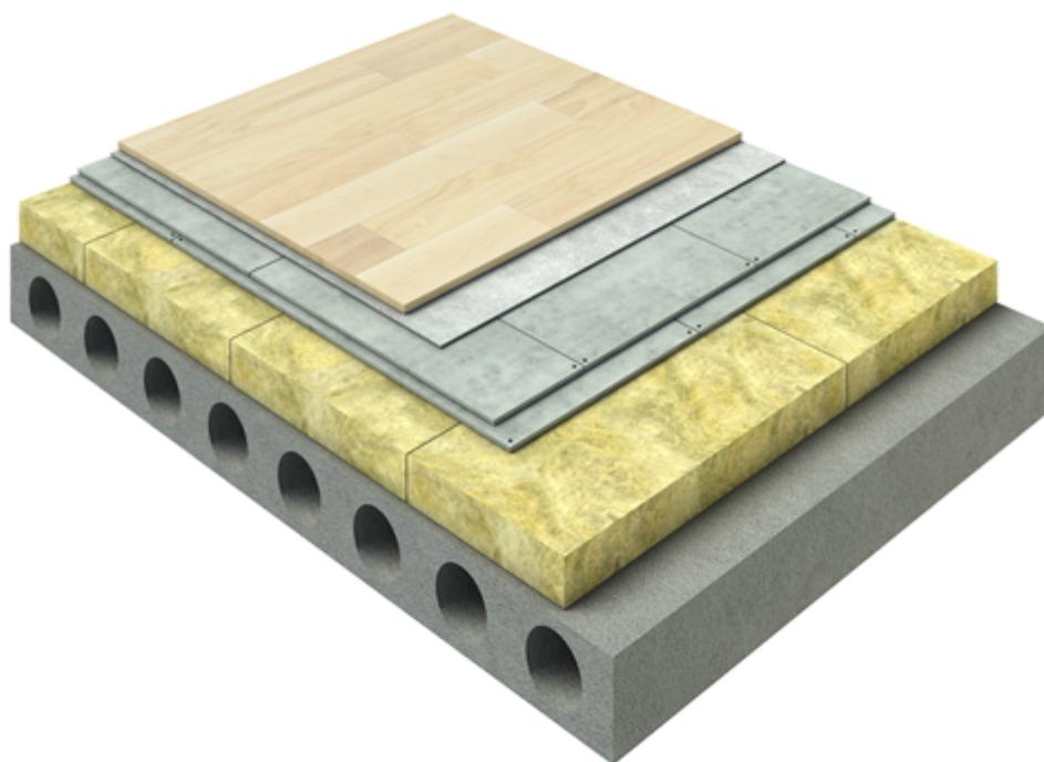
Не нагружаемая каменная вата предполагает, что в процессе эксплуатации утеплитель не будет подвержен механическим нагрузкам. Такая схема работы утеплителя возможна в частных домах с устройством деревянных балочных перекрытий, а также в полах по деревянным лагам, которые являются элементами каркаса, который и воспринимает всю нагрузку от пола перекрытия.
