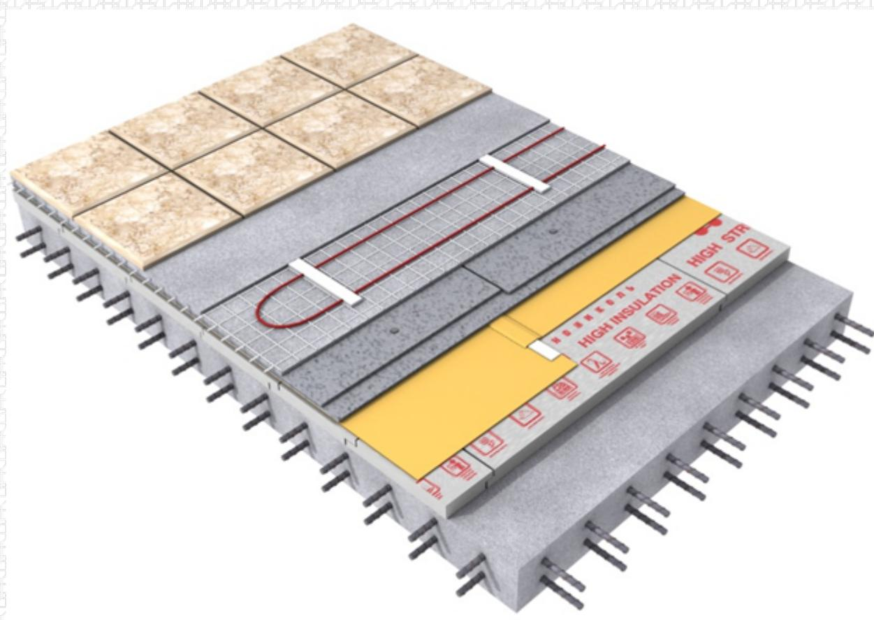
В дополнение ко всему экструзионный пенополистирол обладает способностью поглощать ударный шум от покрытия пола. Именно поэтому данный материал широко применяется и для звукоизоляции перекрытий зданий.
