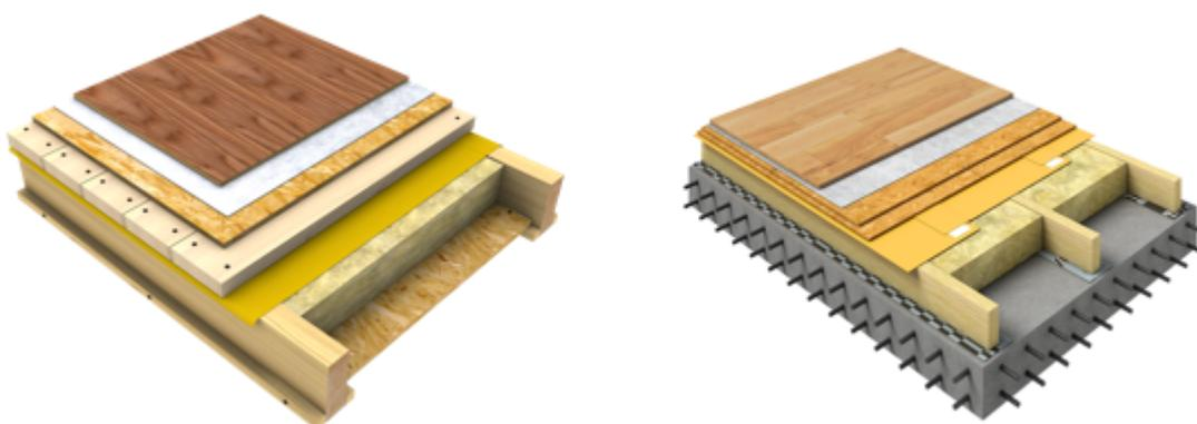
Кроме того, каменная вата является прекрасным звукоизоляционным материалом, что позволяет снизить воздействие воздушного шума между перекрытиями.
