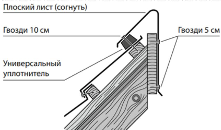
Полукруглые коньковые элементы уложите с нахлестом 2 см и зафиксируйте сверху по краям гальванизированными гвоздями либо гальванизированными саморезами к коньковому брусу. Если кровля односкатная, конек выполните согласно рисунку выше. Плоский лист согните и обрежьте согласно уклону кровли и толщине стропил. Поверх плоского листа в декоративных целях можно закрепить полукруглые коньки.
