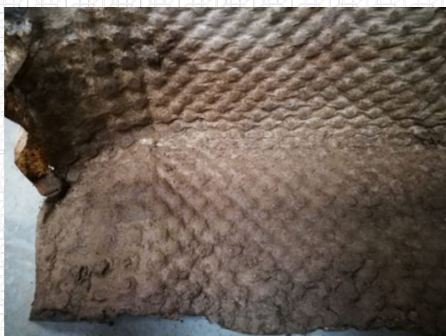
Рис. 8. Заиливание геотекстиля дренажной мембраны.
