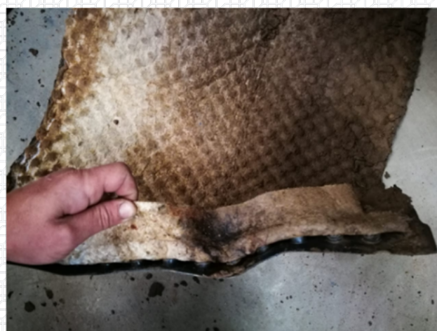
Рис. 8. Заиливание геотекстиля дренажной мембраны.
