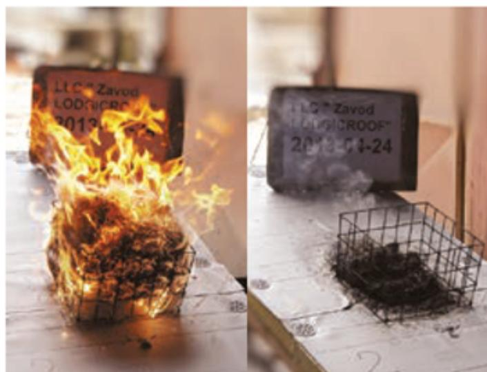
Проводилось на макете по негорючему основанию (минераловатный утеплитель), угол наклона макета - 15 градусов, на поверхность кровельного материала устанавливается корзина, которая наполняется высушенным древесным волокном и поджигается. Во время испытания фиксируется площадь поврежденного пламенем материала.
