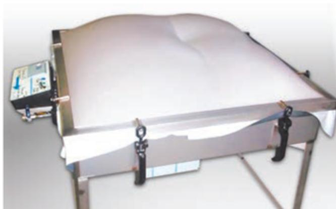
Для оценки надежности кровельных систем с применением ПВХ мембраны LOGICROOF и крепежной системы ТЕХНОНИКОЛЬ были проведены испытания на сопротивление ветровой нагрузки в европейском научном институте BDA Keuringsinstituut B.V., который более 30 лет проводит исследования в области строительства зданий.
