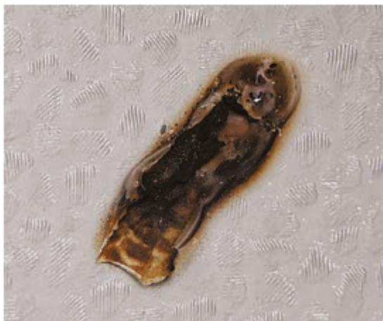
При толщине мембранного покрытия более 1,5 мм тлеющая сигарета повреждает лишь верхний слой мембраны.
