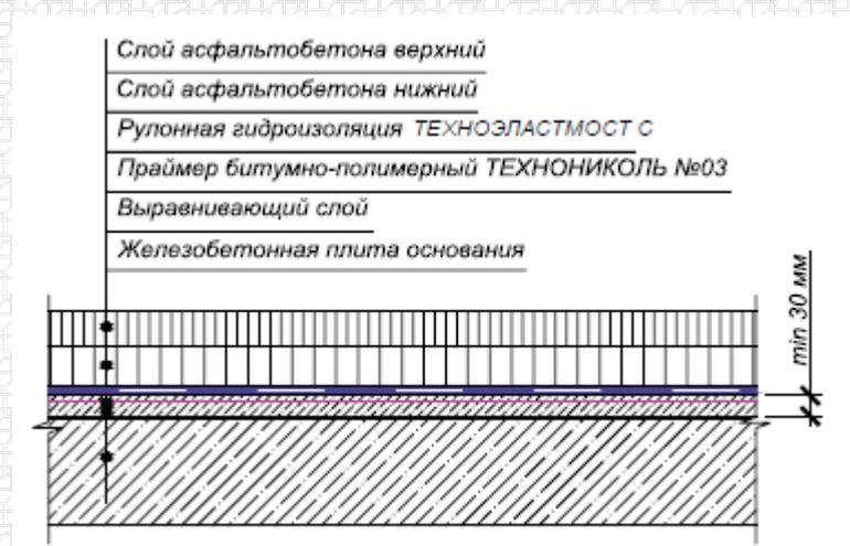
Выравнивающий слой может быть выполнен переменной толщины для придания поверхности
