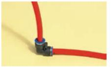
Для удобства монтажа трубок закрепите их на поверхности мембраны небольшим «хлястиком» мембраны. Маркируйте трубки в соответствии с маркировкой штуцеров, с которыми они соединены.
