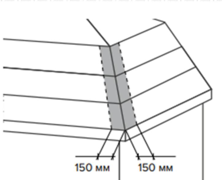
Допускается формирование торцевого элемента из отдельного полотна, уложенного вдоль ребра. При этом нижние полотна подрезаются по линии формирования ребра кровли, а сверху на само ребро, с перехлестом 150мм на обе стороны ската укладывается элемент подкладочного ковра. Место перехлеста промазывается битумной мастикой ТЕХНОНИКОЛЬ №23 Фиксер. Сам элемент, вдоль ската по обе стороны закрепляется ершенными кровельными гвоздями с шагом крепления к основанию 150мм, выполненным в шахматном порядке
