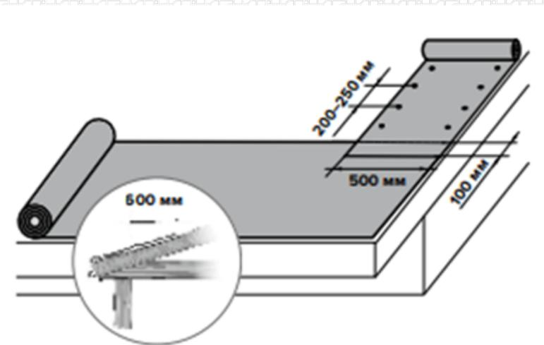
Монтаж самоклеящегося ковра в зоне карнизного и фронтоного свесов. Уложить самоклеящийся подкладочный ковер вдоль карнизного свеса на ширину самого карнизного вылета плюс 600мм от внутренней плоскости наружной стены внутрь здания. Вдоль фронтоного свеса по всей высоте ската уложить самоклеящийся подкладочный ковер шириной 500мм с перехлестом 100мм к смонтированному на карнизе самоклеящемуся коверу
