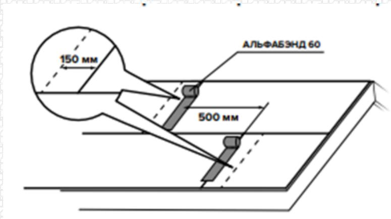
Поперечные нахлесты полимерного ковра АЛЬФА ANDEREP составляют 150 мм. Сверху перехлест проклеивается самоклеящейся односторонней лентой АЛЬФАБЭНД 60. Расстояние между поперечными перехлестами должно быть не менее 500мм.
