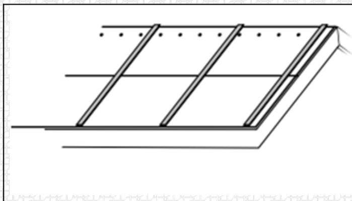
При использовании в качестве временной кровли дополнительно зафиксировать рейками или пятками с шагом 500см.
