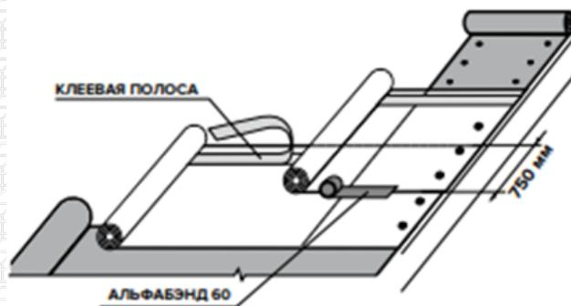
При угле наклона кровли от  $12^\circ$  до  $18^\circ$  ширина перехлеста составляет 750 мм, перехлест фиксируется самоклеящейся односторонней лентой АЛЬФАБЭНД 60.
