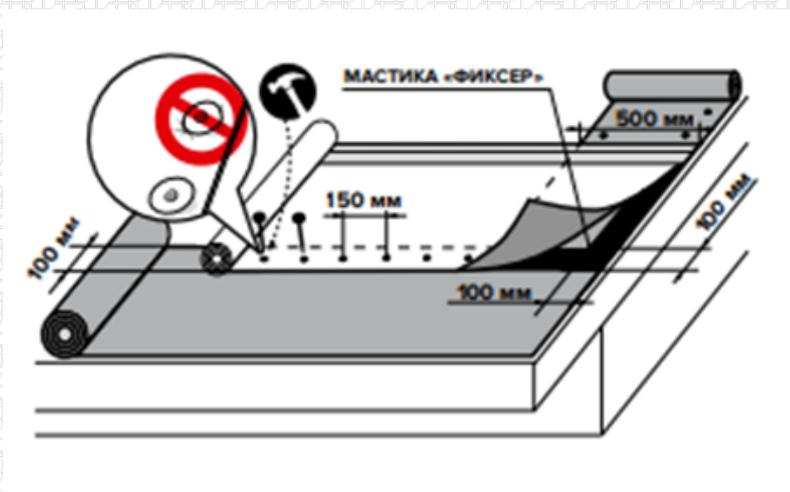
На основной площади кровли АЛЬФА ANDEREP укладывается параллельно карнизному свесу снизу вверх. В зоне фронтового свеса: нахлест Альфа ANDEREP на самоклеящийся ковер составляет 500мм, на место перехлеста наносится битумная мастика «Фиксер», ширина нанесения мастики 100мм вдоль фронтового свеса, толщина нанесения мастики не более 1мм
