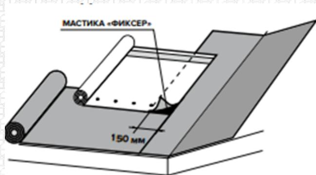
Нахлест АЛЬФА ANDEREP на самоклеящийся подкладочный ковер составляет 150 мм, место перехлеста промазывается тонким слоем битумной мастики «ФИКСЕР», толщина нанесения не более 1мм.
