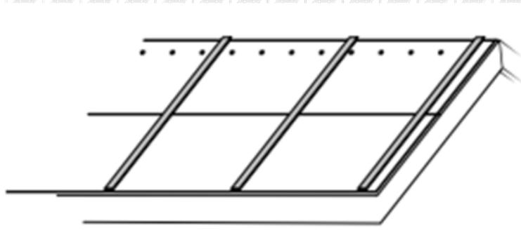
При использовании подкладочного ковра в качестве временной кровли осуществляется механическое крепление только по периметру материала без механической фиксации его по центру (GL / GL LIGHT / GL PLUS / NEXT FIX). После крепления материала, параллельно фронтонному свесу осуществляется дополнительное крепление подкладочного ковра при помощи реек или пятак с шагом крепления 500мм
