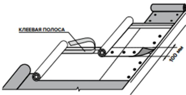
При угле наклона кровли  $> 18^\circ$  ширина перехлеста составляет 100мм
