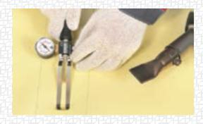
ВАЖНО! Будьте предельно осторожны при вводе иглы, она не должна повредить оборотную сторону воздушного канала
