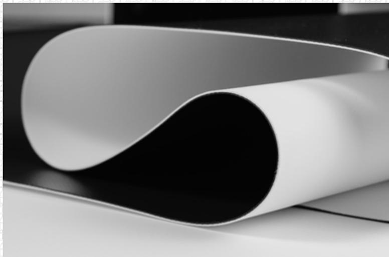
Полимерные мембраны представляют собой гидроизоляционные рулонные материалы, которые изготавливают путем соединения в единое полотно (с армирующей основой из стеклохолста или полиэфирной сетки, или без нее) слоев материала, полученных в результате экструдирования из поливинилхлорида (ПВХ мембраны) или полипропилена (ТПО мембраны) с использованием наполнителей и технологических добавок.
