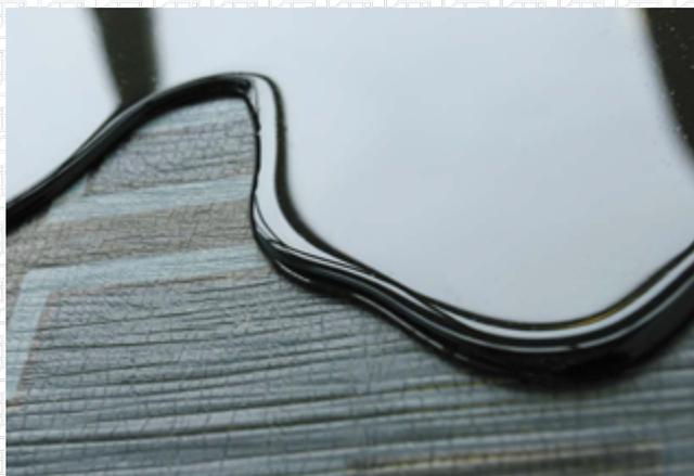
Битумные и битумно-полимерные мастики – это смесь битума, натуральных минеральных добавок и наполнителей различных размеров. На выходе получается вязкая однородная масса, которую достаточно просто налить на плоскую поверхность. После затвердевания битумная мастика для гидроизоляции походит на монолитный материал, напоминающий по виду резину.
