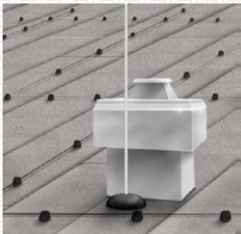
Все элементы молниезащиты должны быть соединены между собой с помощью молниеприемной сетки. Молниеприемная сетка соединяется с тоководами. Тоководы проходят по фасаду здания к заземлителю.
