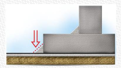
Выполните элемент усиления внешнего угла в месте перехода с бетонной подготовки на вертикальную поверхность фундаментной плиты. Сначала разрежьте и примерьте заготовку по месту.
