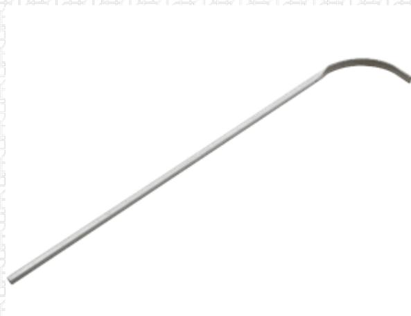
Крючок из тонкой и легкой трубы применяется для разворачивания (раскатывания) материала при наплавлении на основание.
