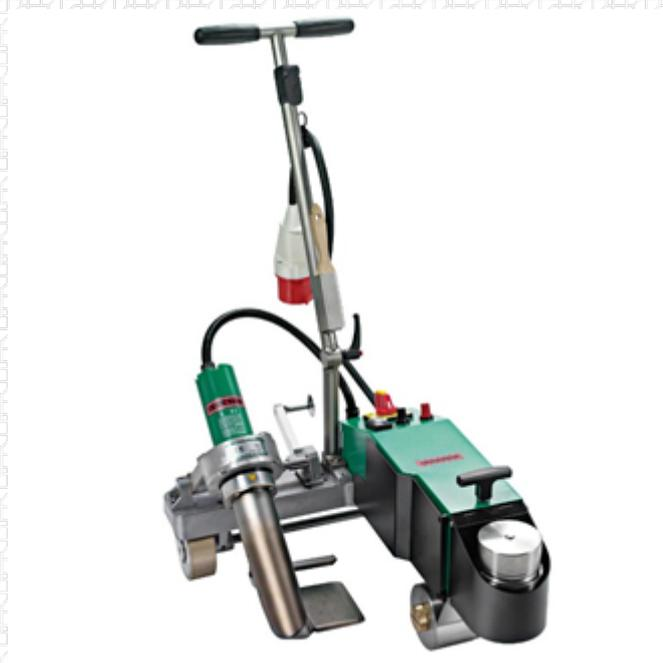
Мощный автомат для сварки внахлест горячим воздухом битумно-полимерных кровельных покрытий. Аналоговое управление, возможность использования дополнительных грузов, тахогенератор для стабилизации скорости сварки.
