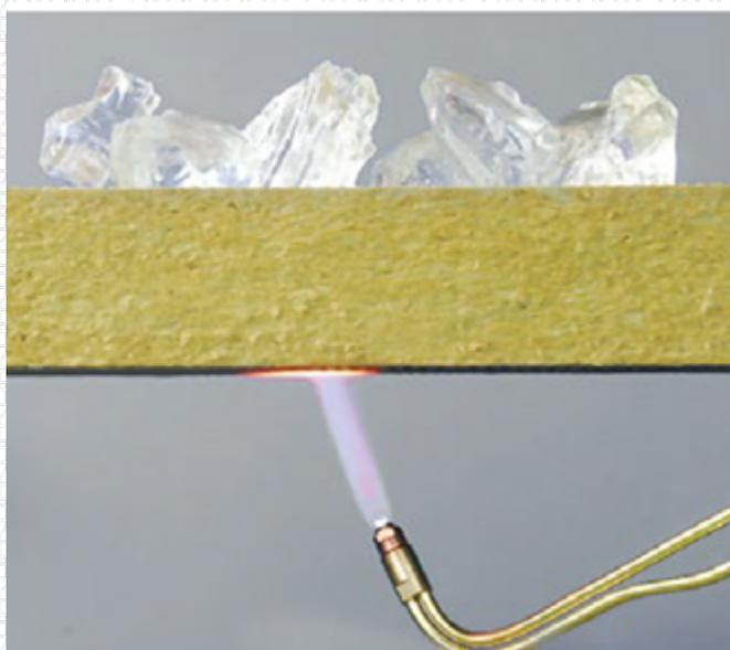
**Важно! Пределы огнестойкости некоторых конструкций с применением огнезащитной каменной ваты могут достигать 240 мин.**
