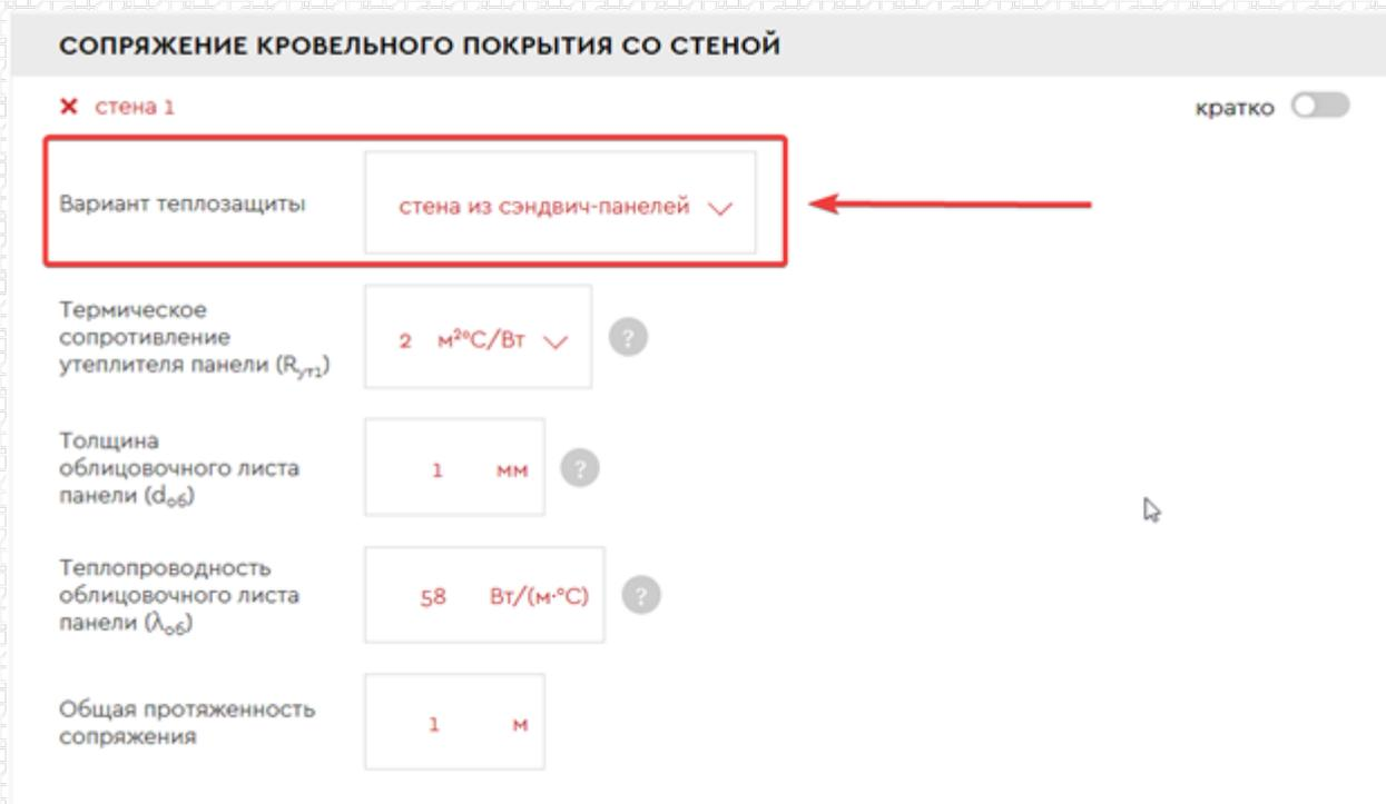
**СОПРЯЖЕНИЕ КРОВЕЛЬНОГО ПОКРЫТИЯ СО СТЕНОЙ**
