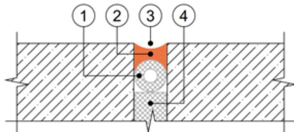
1 — шнур типа «Вилатерм»; 2 — герметик; 3 — зазор шва; 4 — экструзионный пенополистирол
