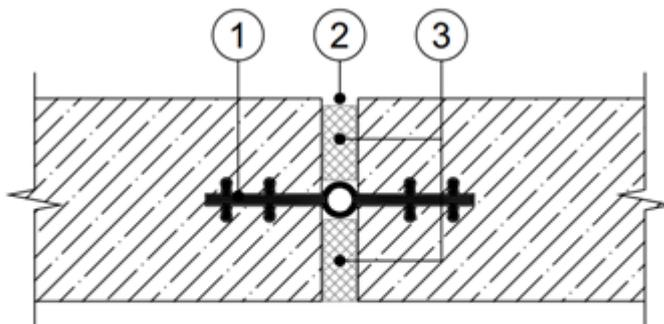
1 — гидроизоляционный элемент; 2 — зазор шва; 3 — наполнитель полости шва
