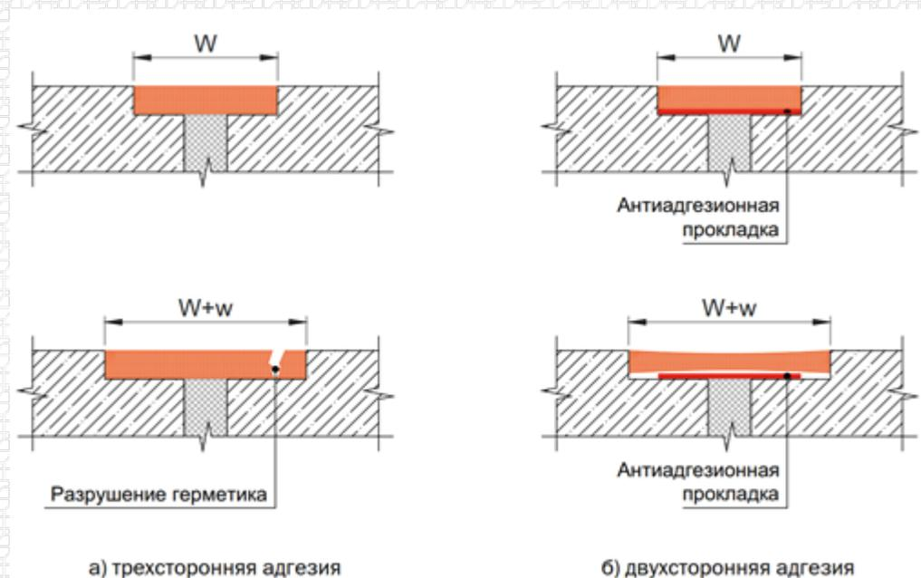
В качестве антиадгезионной прокладки можно использовать скотч или полиэтиленовую пленку. Широкое применение для данных целей нашел шнур «Вилатерм» - вспененный полиэтилен, который обеспечивает отсутствие адгезии с герметиком и создает форму шва.
