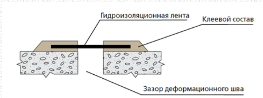
При значительных деформациях конструкции гидроизоляционная лента монтируется с компенсатором, что существенно повышает надежность уплотнения деформационного шва. Кроме того, гидроизоляционная лента может быть уложена в подготовленную штрабу, что позволяет сохранить начальный профиль конструкции.
