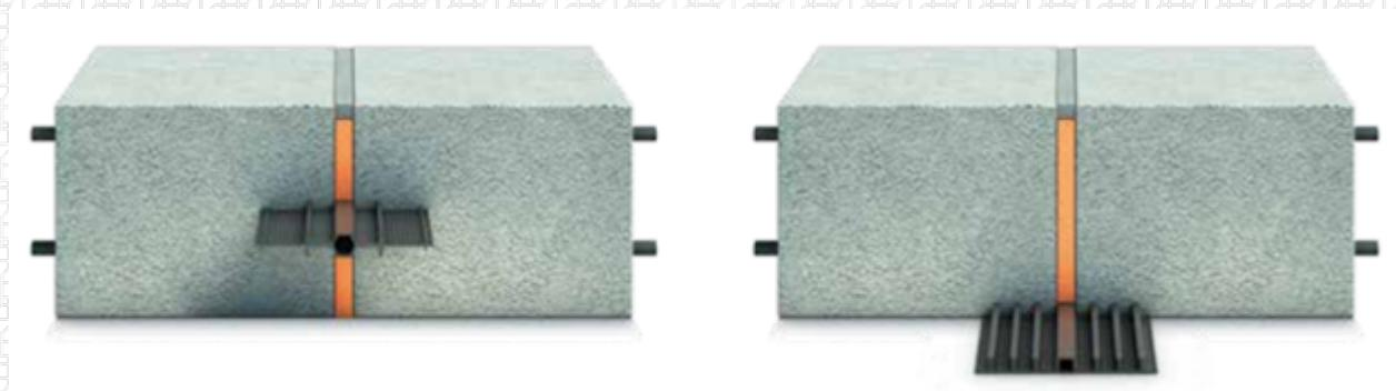
Так же, как и гидрошпонки для технологических швов, шпонки для деформационных швов подразделяются на внутренние/центральные/двухсторонние (располагаются в центре массива бетона и развязываются к арматуре) и внешние/боковые/односторонние (располагаются с боку массива и крепятся к опалубке). Основные параметры шпонок, физико-механические характеристики и монтажные схемы можно найти в технических листах на материалы и альбоме технических решений Компании ТЕХНОНИКОЛЬ.
