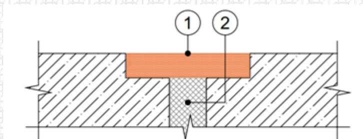
1 — герметик; 2 — наполнитель полости шва
