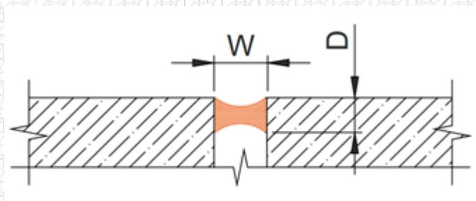
Когда коэффициент формы в шве для герметика равен или меньше единицы, обеспечиваются наилучшие условия реализации его эластомерных характеристик. И наоборот, чем больше коэффициент формы, тем меньшую величину зазора в шве может обеспечить герметик.
