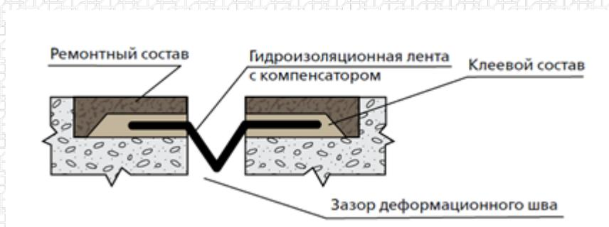
В процессе установки гидроизоляционная лента может быть состыкована с гидроизоляционной мембраной, при этом следует учитывать совместимость материалов между собой. Оптимальным вариант – когда гидроизоляционная мембрана и гидроизоляционная лента изготавливаются из одного и того же типа материала.
