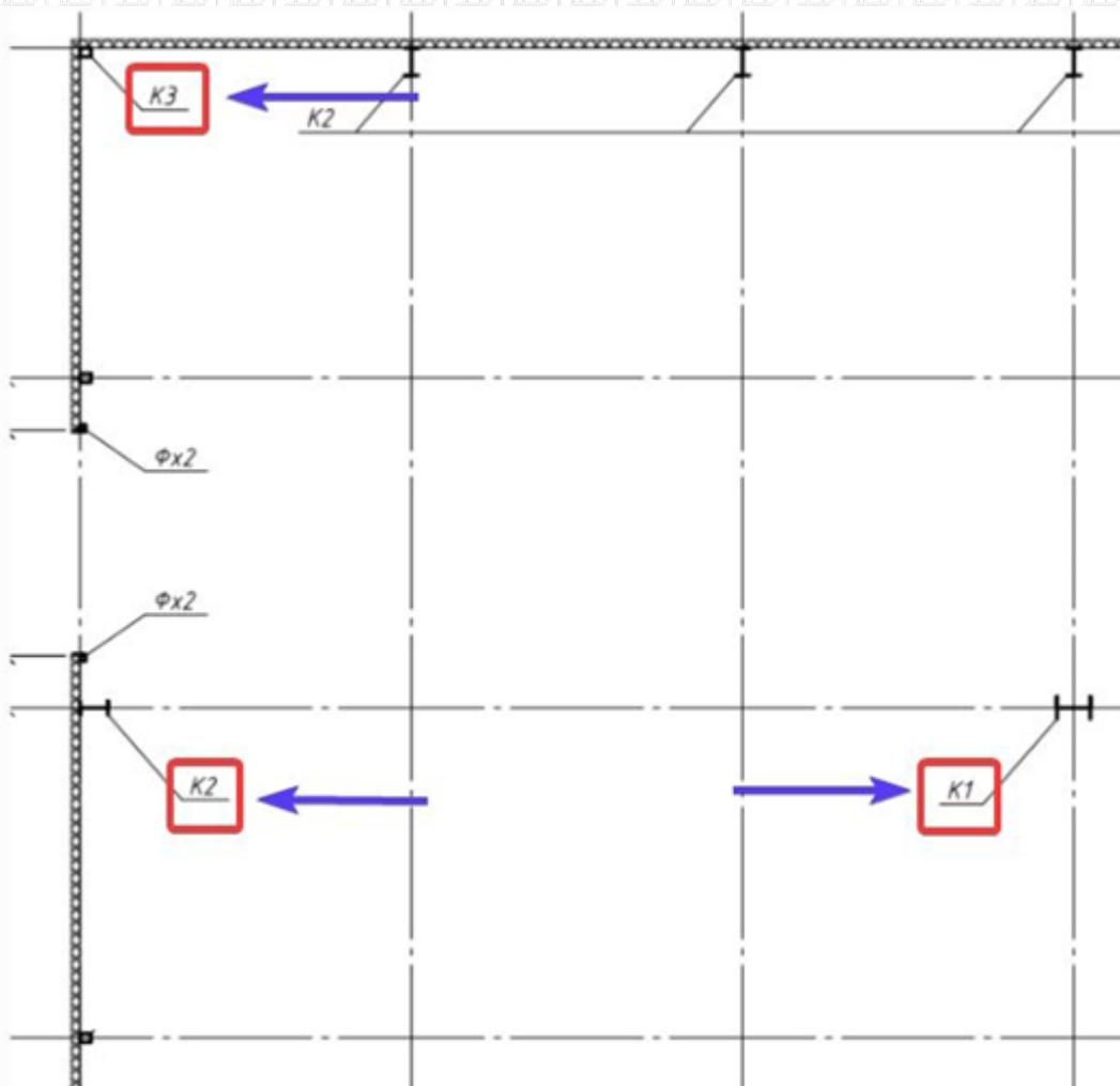
Центральные колонны К1 при возникновении пожара, подвергнутся воздействию огня с четырех сторон. Колонны К2 расположенные вдоль внешних стен с трех направлений, угловые колонны только с двух.
