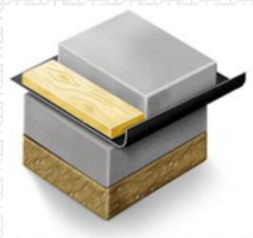
В месте будущего соединения горизонтальной и вертикальной гидроизоляционных мембран защиту выполните щитовыми материалами (листами фанеры и т. д.), что позволит защитить мембрану от механического повреждения и быстро их разобрать при дальнейших работах по наплавлению.
