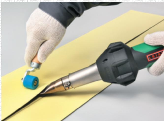
Выдерживая дистанцию в 5-7 мм, прикатывайте ролик параллельно кромке сопла. Не позволяйте ролику догнать сопло.
