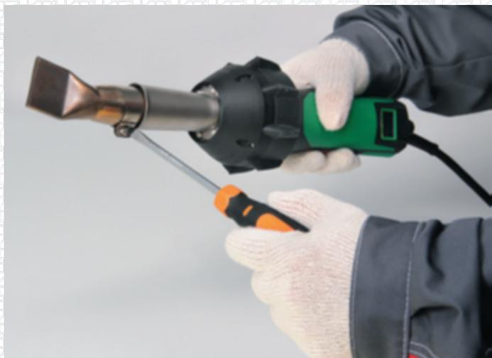
Для включения аппарата нажмите кнопку включения и удерживайте ее несколько секунд. Для сварки мембраны LOGICBASE V-SL выберите температуру 400–510 °С в зависимости от погодных условий и скорости сварки. После включения фена на нагрев подождите 2–3 минуты до прогрева воздуха.
