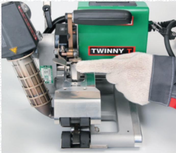
После такой регулировки при зажиме двух слоев мембраны между роликами при выполнении сварки на материал будет оказываться необходимое давление 600 Н.
