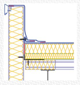
Для парапетов высотой более 350 мм используйте завершение с краевой рейкой. Крепите краевую рейку начиная от середины, чтобы можно было равномерно натянуть мембрану по всей длине парапета. Для натяжения мембраны используйте «зажим кровельщика».
