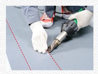
Со стороны нижнего края заготовки приварите полосу для кармана по длине с помощью автоматического оборудования.
