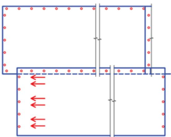
Приварите длинную сторону полотна с помощью автоматического оборудования.
