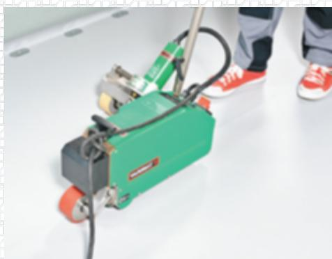
Извлеките металлические пластины из начала и окончания шва и выполните сварку оставшихся участков вручную.
