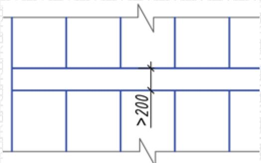
В случае невозможности осуществить монтаж полотен мембраны без смещения торцов уложите сборную полосу поперек основных полотен. Ширина сборной полосы должна составлять не более **1 м**.
