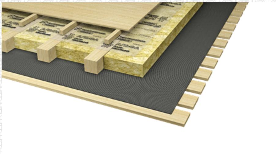
Со стороны помещения первой идет пароизоляционная пленка, далее теплоизоляция и со стороны подполья теплоизоляцию закрывает диффузионная мембрана.
