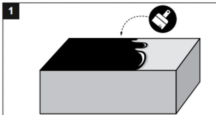
1. На основание, обработанное мастикой уложить материал так, чтобы он выступал за габариты будущих стен на ширину не менее 25-50мм.
