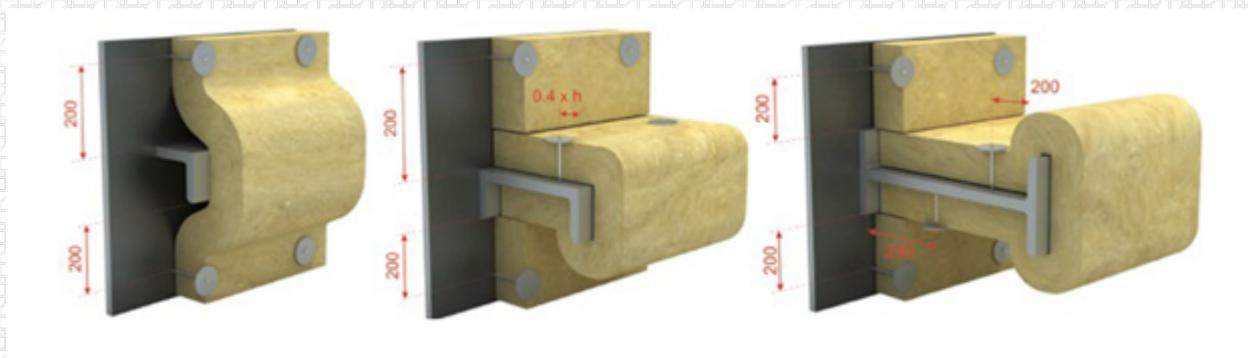
При изоляции технологических отверстий и смотровых люков основной слой теплоизоляции подводится вплотную к опорным элементам, установленным по периметру.
