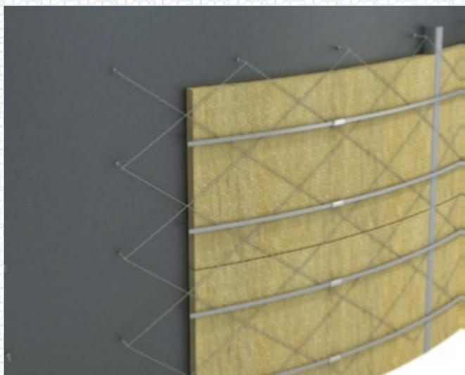
В случае, если установка штырей не представляется возможным, плиты фиксируются при помощи проволоки диаметром 2 мм. Для этого необходимо предусмотреть опорные конструкции (планки, уголки, струны и т.д.) с шагом 3000-5000 мм, к которым будут вязаться струны.
