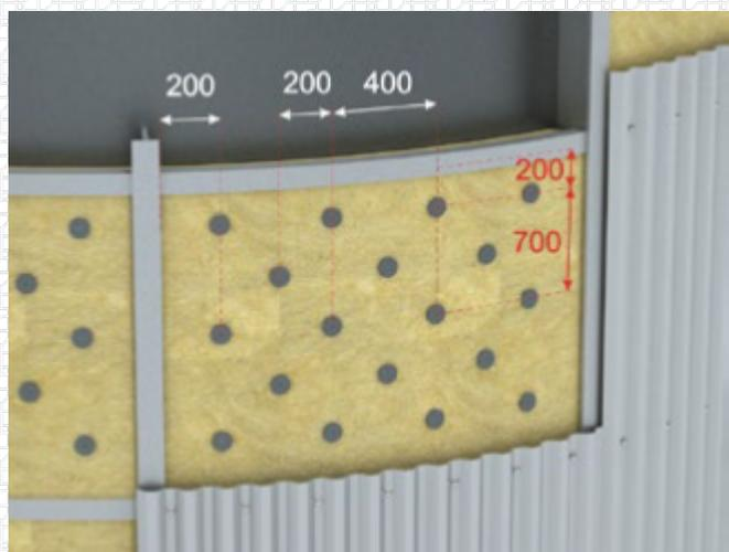
Если на поверхности вертикальной емкости допускается сварка, то крепление при помощи штырей или штифтом будет наиболее оптимальным способом крепления. Для этого к корпусу изолируемой емкости привариваются штыри или штифты с шагом 300-500 мм по горизонтали и вертикали и отступом от опорных колец и стоек 200 мм. Далее навешиваем теплоизоляционный материал и фиксируем при помощи прижимной шайбы (для штифтов) или загнув штырь и сравняв его с плоскостью изоляции.
