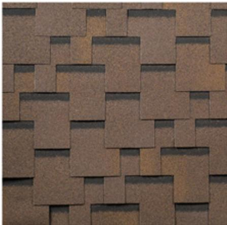
Гибкая черепица ТЕХНИКОЛЬ, серия ОПТИМА это штучный, битумосодержащий кровельный материал. Изготавливается нарезанием листов из рулонного материала, получаемого путем пропитки и покрытия стекловолокнистой основы битумным вяжущим, с последующим нанесением различных видов защитных покрытий. Гарантийный срок службы – 10 лет.
