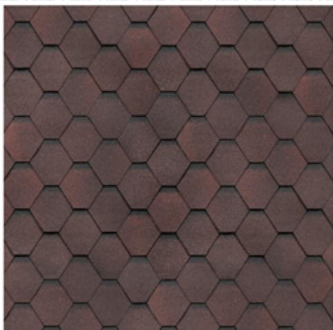
Гибкая черепица ТЕХНОНИКОЛЬ, серия УЛЬТРА – это штучный битумосодержащий кровельный материал. Изготавливается нарезанием листов из рулонного материала, получаемого путем пропитки и покрытия стекловолоконистой основы битумно-полимерным вяжущим, с последующим нанесением различных видов защитных покрытий. В Серии УЛЬТРА представлены две формы нарезки: «соната», «аккорд». Гарантийный срок службы – 50 лет.
