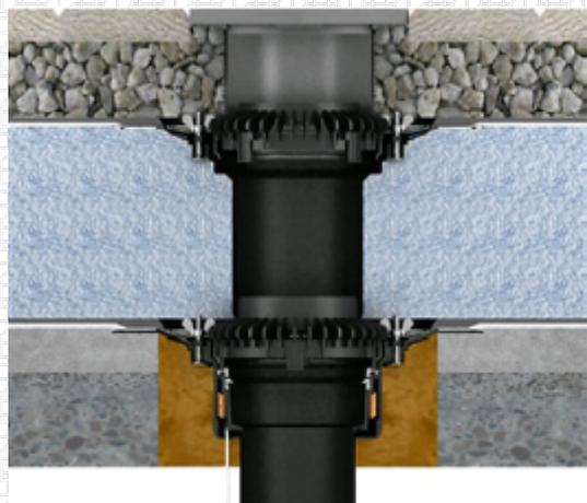
В системах водоотведения эксплуатируемых крыш используются многоуровневые воронки, обеспечивающие отвод воды не только с поверхности крыши, но и с уровня дренажного слоя и водоизоляционного ковра. При этом используются дополнительные элементы воронок:
