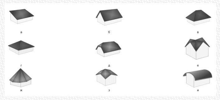
а - односкатная; б - двускатная; в - вальмовая четырехскатная; г - шатровая; д полувальмовая; е - многощипцовая; ж - шпилеобразная; з - из косых поверхностей; и сводчатая
