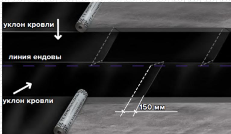
Торцевые нахлесты соседних полотенц кровельного материала должны быть смещены относительно друг друга не менее чем на 500 мм.
