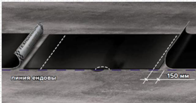
Для увеличения надежности и герметичности торцевого нахлеста рекомендуем осуществить подрезку угла полотна материала, находящегося в нахлесте снизу. Подрезку проводите под углом 45°.
