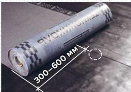
Стыки торцевых нахлестов материалов смежных слоев не должны совпадать. Рекомендуется смещать торцевые нахлесты смежных слоев на расстояние не менее 500 мм.
