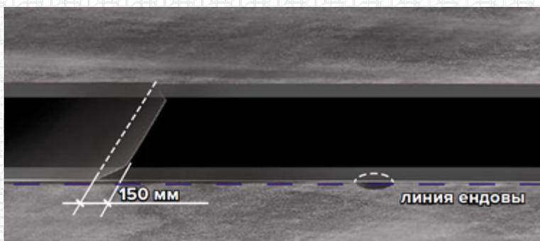
Последующая укладка и подрезка угла рулонов:
