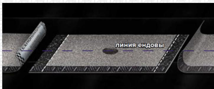
Для увеличения надежности и герметичности торцевого нахлеста рекомендуем осуществить подрезку угла полотнища материала, находящегося в нахлесте снизу, и затем удалите крупнозернистую посыпку. Подрезку проводите под углом 45°.
