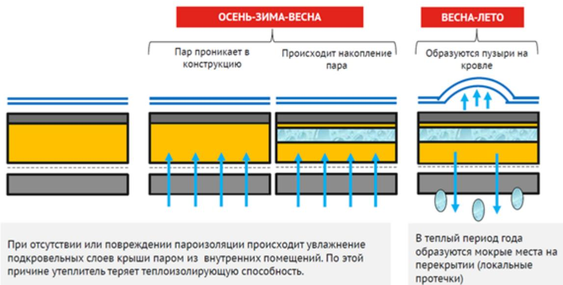
Основным правилом пароизоляции конструкции является увеличение паропроницаемости материалов конструкции от теплой поверхности к холодной. Поэтому паробарьер располагают на наиболее теплой (обладающей большим содержанием влаги в воздухе) стороне стены, перекрытия или пола.
