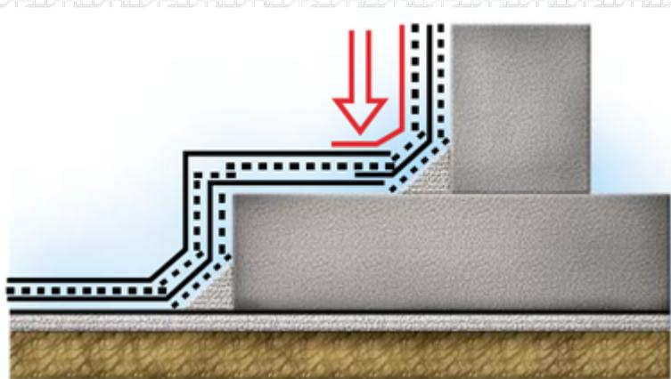
Выполните наплавление второго слоя гидроизоляционной мембраны в зоне внешнего угла по вертикальным ограждающим конструкциям.
