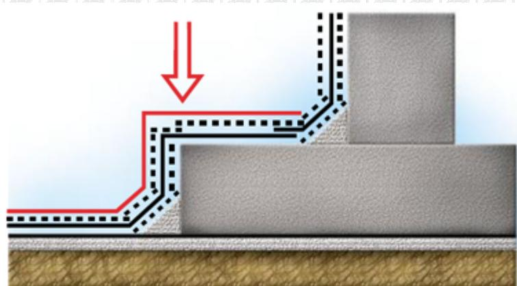
Выполните наплавление второго слоя вертикальной гидроизоляционной мембраны в зоне внешнего угла по описанной выше технологии. Сначала по фундаментной плите.
