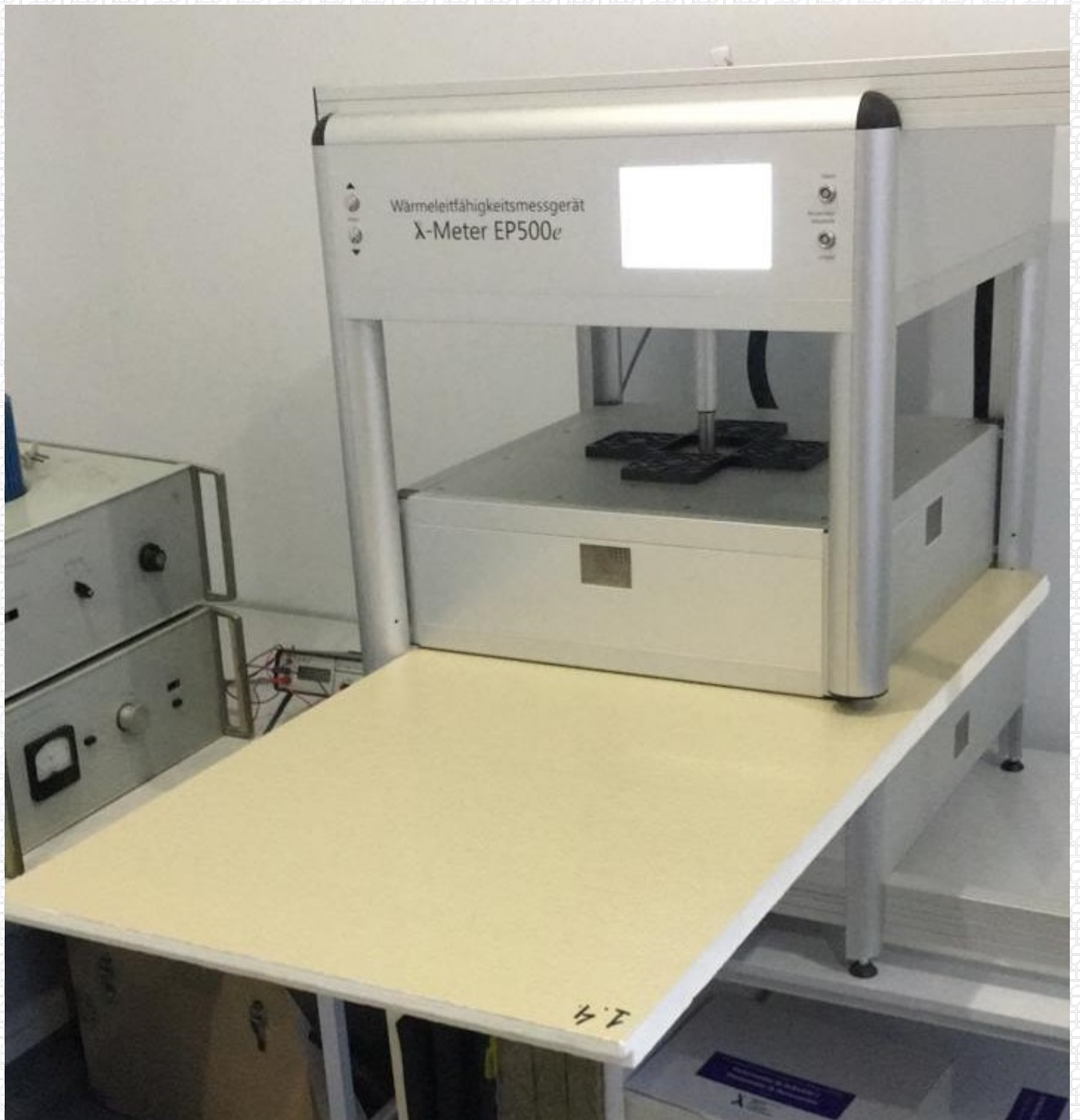
Рис. 1 Испытание цельной плиты LOGICPIR PROF Ф/Ф на приборе Lambda-Meter EP500e
